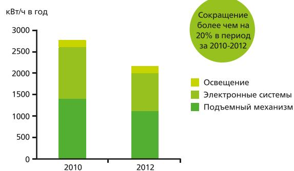
Основой расчета является лифт со скоростью 1.6 м/с, грузоподъемностью 1000 кг, высотой подъема 45 м (15 этажа), 200.000 пусков/год
